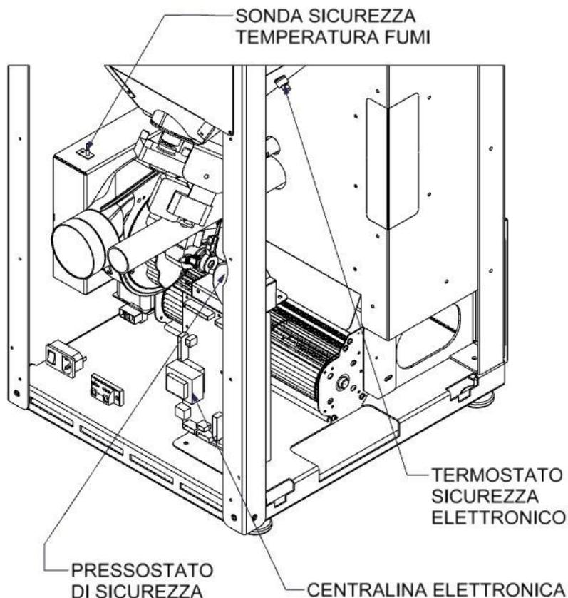
Figura 3 Posizione dei sensori di controllo e dispositivi di sicurezza
