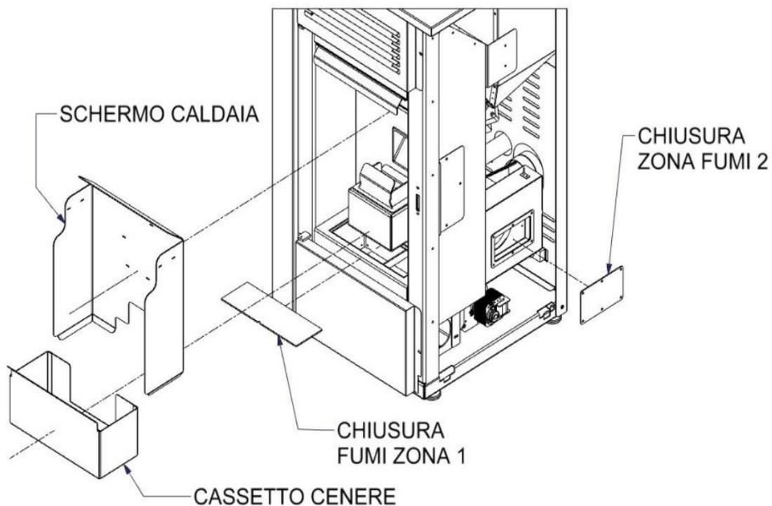
**Figura 8 Caldaia completa e Caldaia con particolari rimossi per pulizia**
