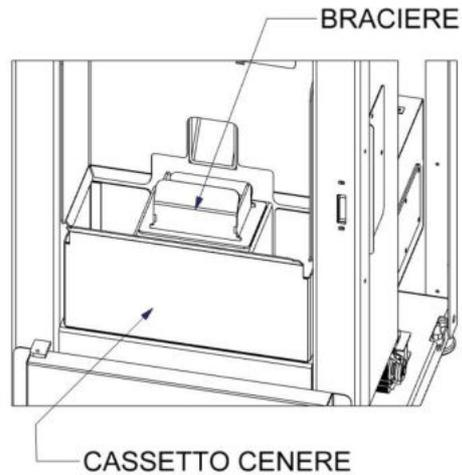
**Figura 7 Camera di combustione.**
