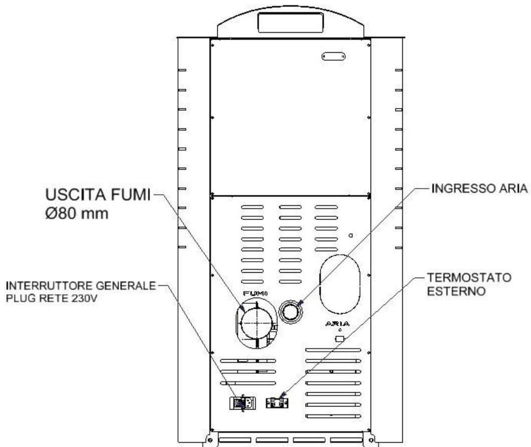
**Figura 1 Parte Posteriore stufa**
