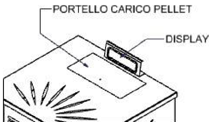
Figura 6 Vano Serbatoio Pellet
